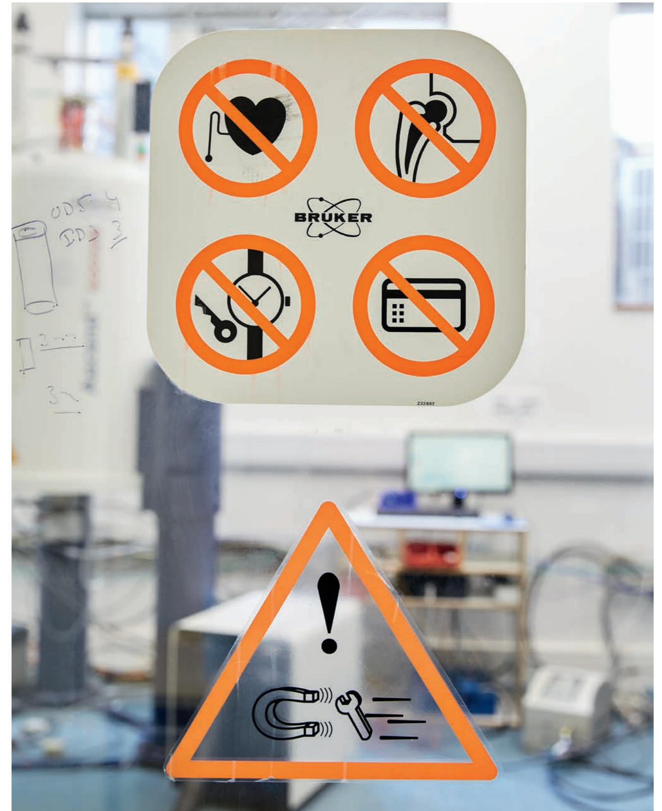
Warnhinweise auf der Tür des NMR-Labors: Im starken Magnetfeld des NMR-Spektrometers können Herzschrittmacher ihre Funktion einstellen. Auch der Zugang mit künstlichen Gelenken ist verboten. Besonders gefährlich sind vom Magneten angezogene Metallgegenstände, die Personen verletzen und den Magneten zerstören können. Kreditkarten können ihre magnetisch gespeicherten Informationen verlieren. Warning signs on the door of the NMR laboratory. In the strong magnetic field of the NMR spectrometer, heart pace makers can stop functioning. Entrance with artificial joints is also forbidden. Particularly dangerous are metal objects attracted by the magnets, which could injure people and destroy the magnets. Credit cards could also lose the information they store magnetically.
