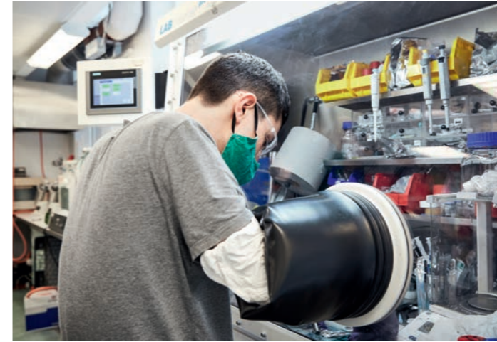
Ein Doktorand montiert Batterie-Testmuster in einer Argon-Schutzatmosphäre. A doctoral candidate is mounting a battery prototype in an argon protective atmosphere.
