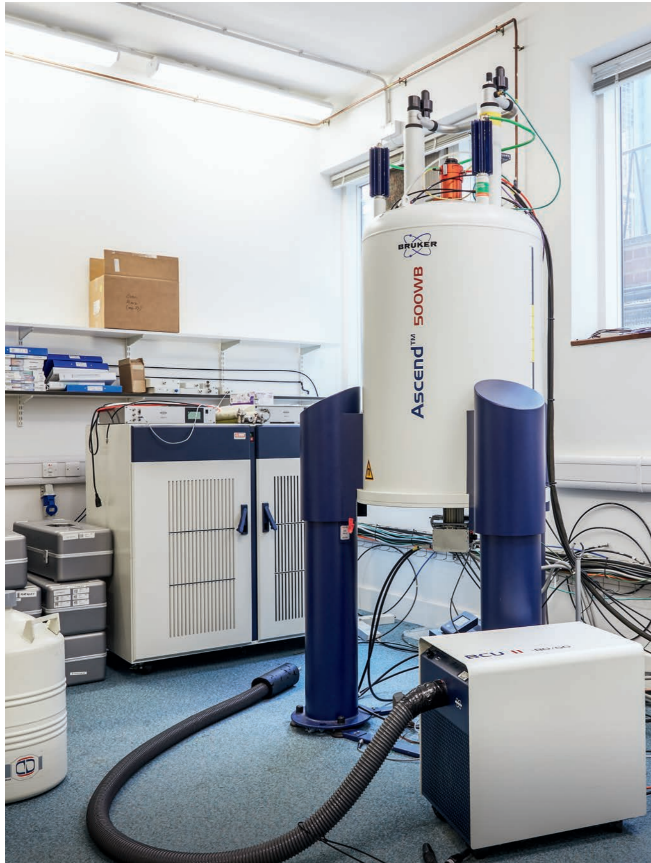
NMR-Spektrometer im Labor von Clare Grey. Der darin enthaltene Elektromagnet erzeugt ein Magnetfeld, das etwa 260.000-mal so stark ist wie das der Erde. Im Innern dieses Spektrometers kann Greys Team unter anderem Mini-Versionen neuartiger Lithium-Akkus in laufendem Betrieb testen. An NMR spectrometer in Clare Grey's laboratory. The electromagnet in it produces a magnetic field that is approximately 260,000 times as strong as that of the Earth. Inside this spectrometer, Grey's team can, for example, test mini versions of novel lithium rechargeable batteries while they are in operation.
