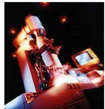
Das Spezial-Elektronenmikroskop für die atomare Elektronenholographie. Nach den Spezifikationen der Tübinger Wissenschaftler von der Firma Philips gebaut, erlaubt es derzeit die holographische Abbildung von 0.13 nm feinen Strukturen. Ziel ist 0.1 nm. Foto: Peter Allert
